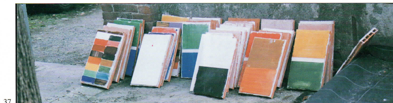
34-37. Preparazione delle tinte della tavolozza dei colori delle facciate del Castello, in base ai campioni d’intonaco, e loro riproduzione a calce a secco su pannelli e a fresco su tavelle in cotto.
